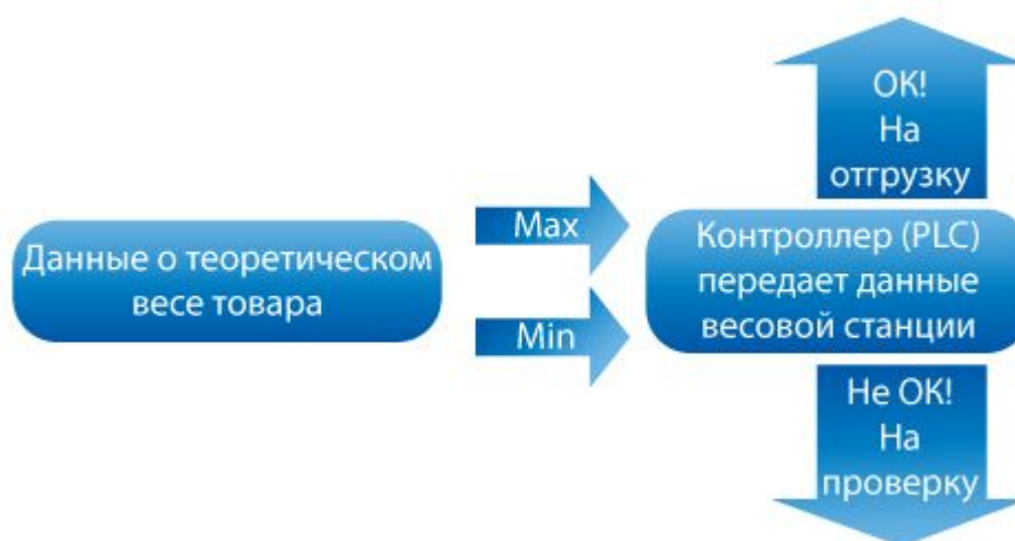
Рис. 58. Схема осуществления контроля комплектации по весу
