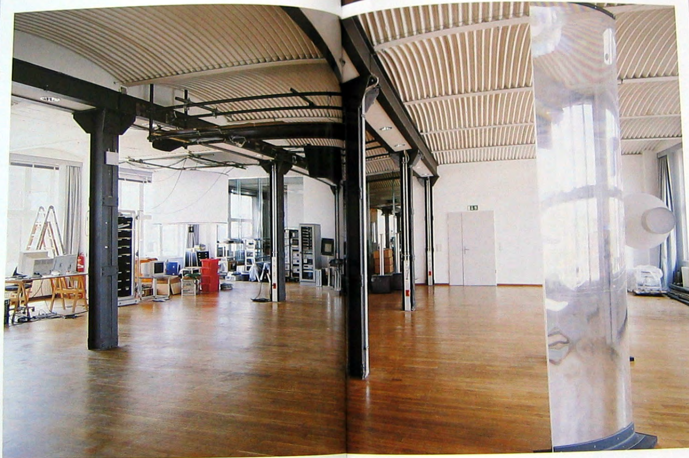
In der Multimedia-Werkstatt blieben die gusseisernen Träger sowie die Kappendecken der alten Bausubstanz erhalten. ■
