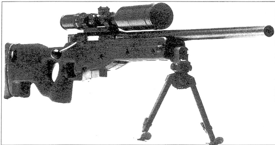
Типичный телескопический прицел фирмы «Шмидт и Бендер», установленный на винтовке АВП.
