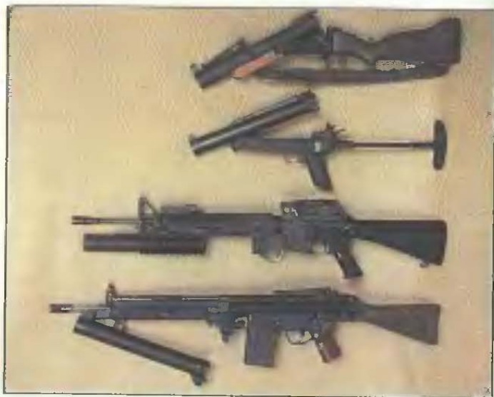
40-мм противопехотные гранатометы в положении для заряжания: М79, НК69А1, М203, НК79
