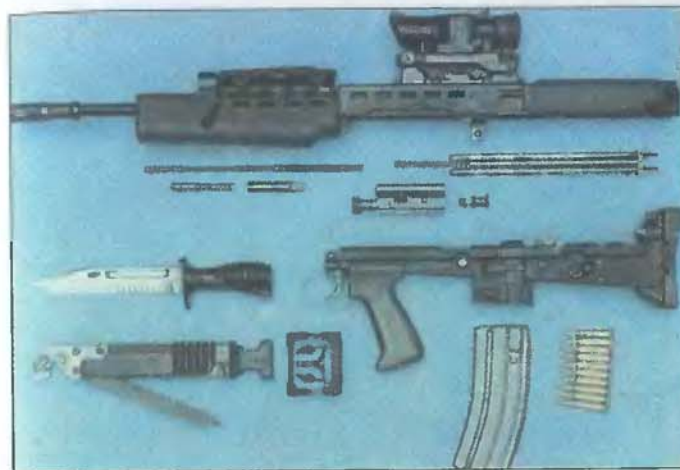
Неполная разборка винтовки L85A1 (Великобритания)
