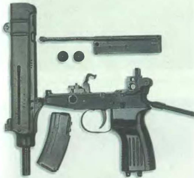
Неполная разборка пистолета-пулемета «Скорпион» Vz.61 (Чехословакия)
