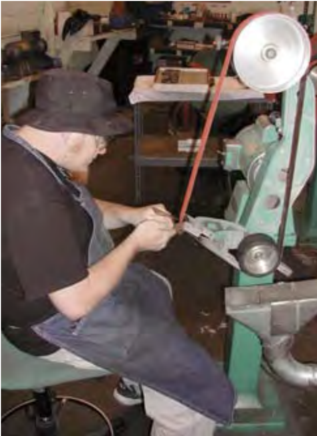
Окончательная доводка ножей производится вручную
