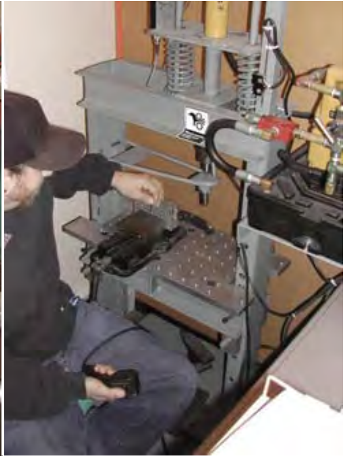
Специалисты компании разработали и создали уникальное устройство для испытания прочности замка
