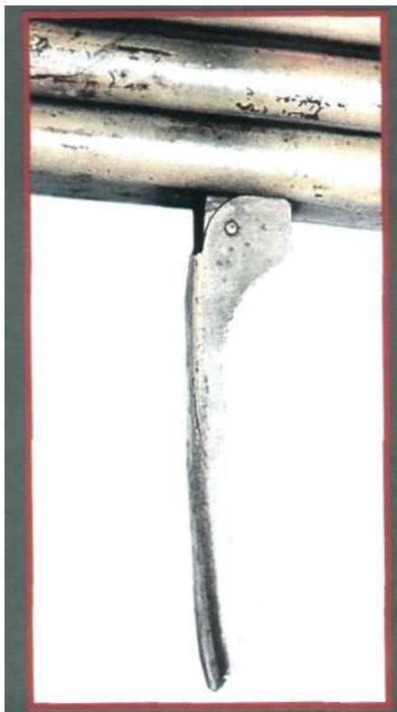
Откидной плечевой упор ПЗРК Luftfaust-B (вид сбоку)
