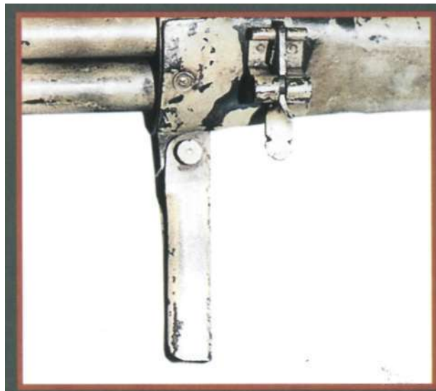
Фиксатор ударного стержня ПЗРК Luftfaust-B, закрепленный на задней рукоятке управления огнем (вид сбоку)
