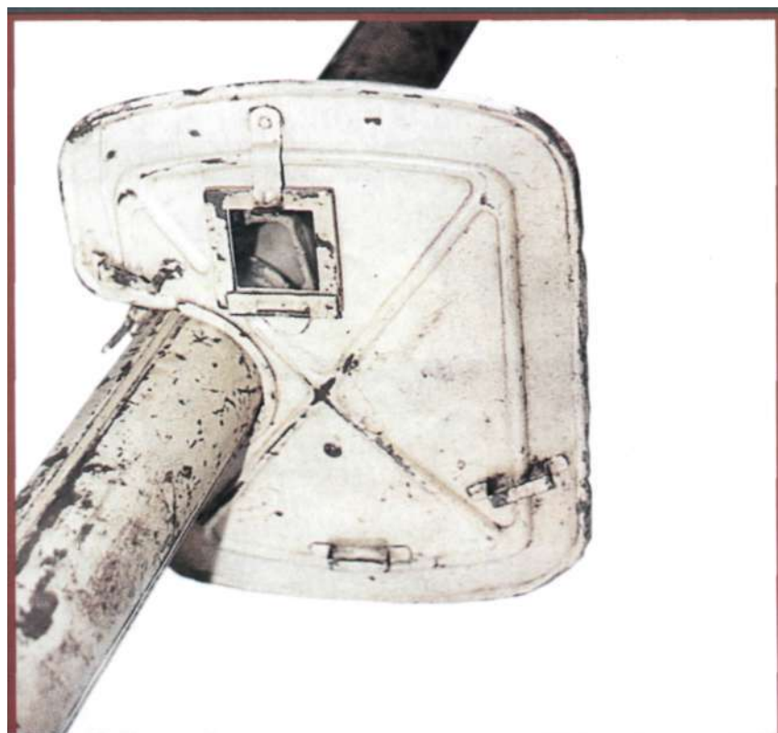
Смонтированный защитный металлический щиток на 88-мм реактивном ручном противотанковом гранатомете RPzB.54 «Panzerschrek» (вид спереди), с окошком для наведения гранатомета на цель
