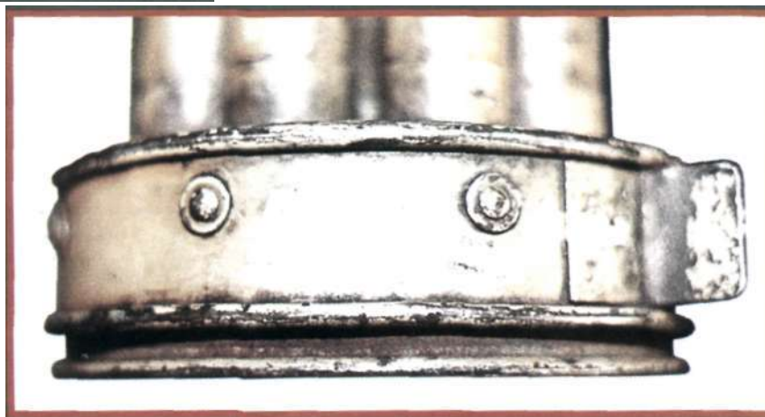
▲ Механизм электровоспламенения переносного ракетного комплекса Luftfaust-B (вид снизу)
