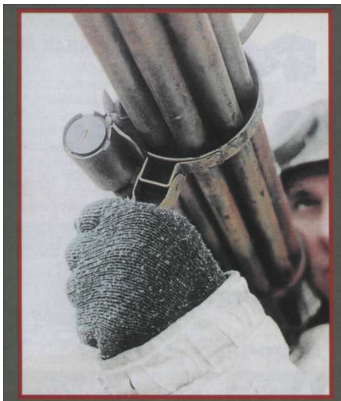
ПЗРК Luftfaust-B в боевом положении (реконструкция) (вид спереди). Стрельба последовательно двумя залпами, сначала одновременным запуском пяти ракет, а затем с замедлением в 0,1 с, оставшихся четырех
