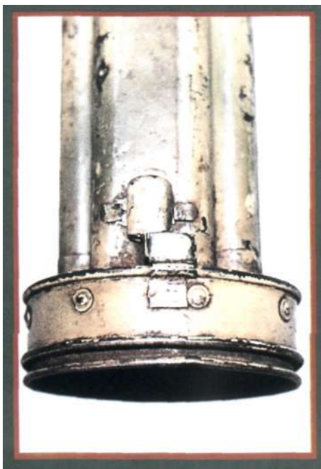
Поддон переносного зенитного ракетного комплекса Luftfaust-B, на котором крепился 9-зарядный магазин (вид снизу)
