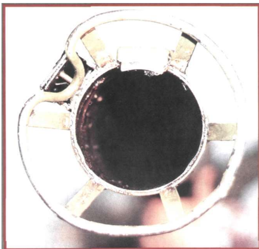
Прицельные приспособления 88-мм реактивного ручного противотанкового гранатомета RPzB.54 «Panzerschrek» - рамочный целик (вид спереди)
