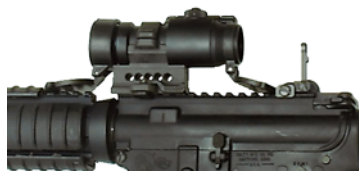
Вид на ствольную коробку винтовки M16A3 с оптическим прицелом Trijicon ACOG, установленным на направляющую типа Picatinny
