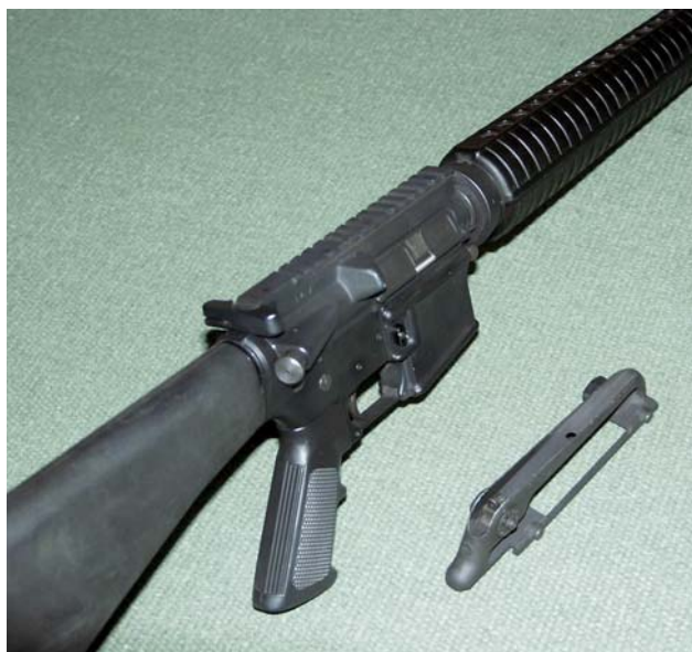
Винтовка DIEMACO C7A1 со снятой рукояткой для переноски. Хорошо видны направляющая типа Picatinny на ствольной коробке и диоптрический прицел в рукоятке для переноски (фото: Кристиан Овергаард, Дания)
