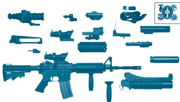
Комплект оборудования SOPMOD Kit для карабина М4А1, разработанный для сил специальных операций США
