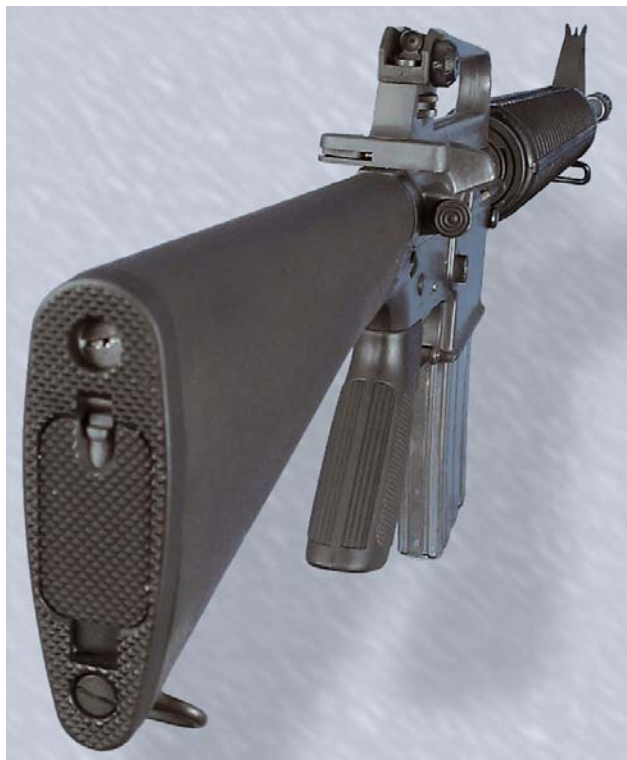
«Традиционные» диоптрические прицельные приспособления американской винтовки M16A2
