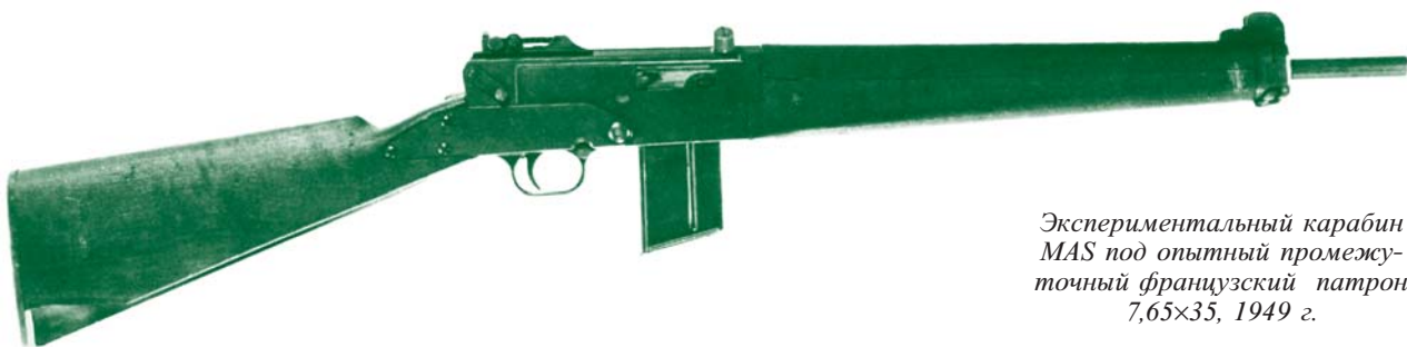
Экспериментальный карабин MAS под американский патрон .30 M1 Carbine, 1949 г.
