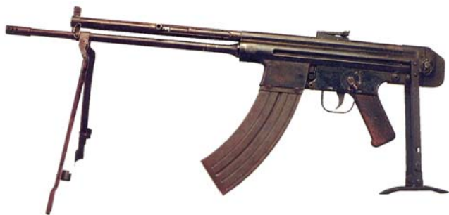
Экспериментальный автомат CETME под патрон 7,92 мм со складным прикладом
