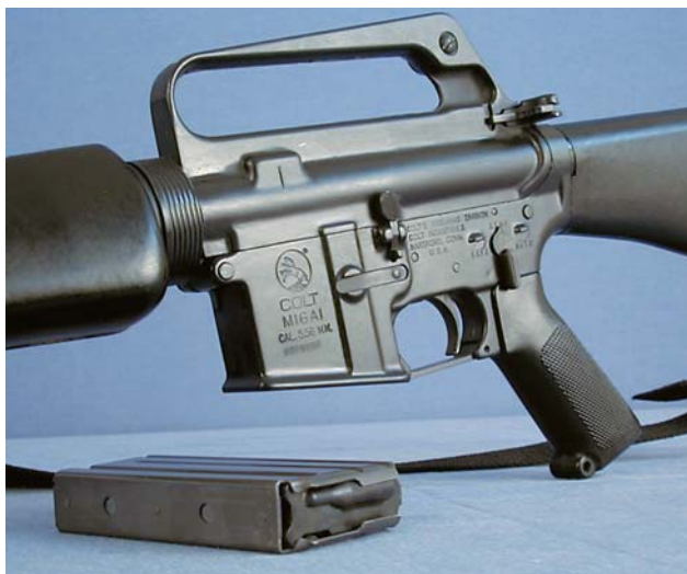
Винтовка M16A1 производства фирмы «Колт», вид на ствольную коробку и горловину магазина (фото: Scottsdale Gun Club, США)
