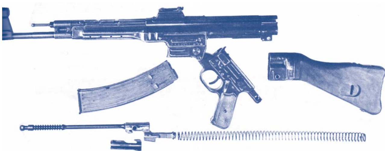
Неполная разборка автомата MP-44/Stg.44. Хорошо видно различие в устройстве с автоматом Калашникова
