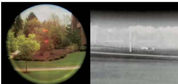
Изображение в телевизионном прицеле XM-29: слева — дневной режим, справа — ночной (инфракрасный) режим
