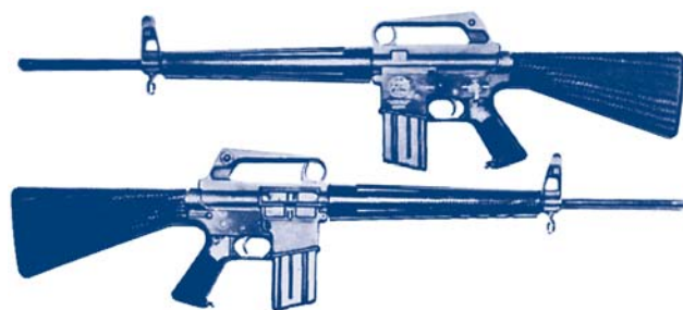
Ранний экспериментальный вариант винтовки AR-15 еще под патрон .222 Remington. Рукоятка взведения затвора расположена аналогично винтовке AR-10, под рукояткой для переноски
