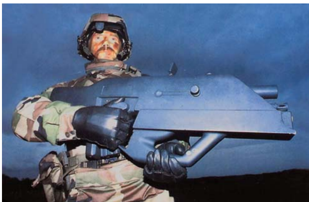
Макет системы PAROP в руках французского солдата. Хорошо видны стволы 35-мм гранатомета и 5,56-мм винтовки под ним, а также небольшой поворотный экран-видеоискатель прицела на верхней поверхности оружия
