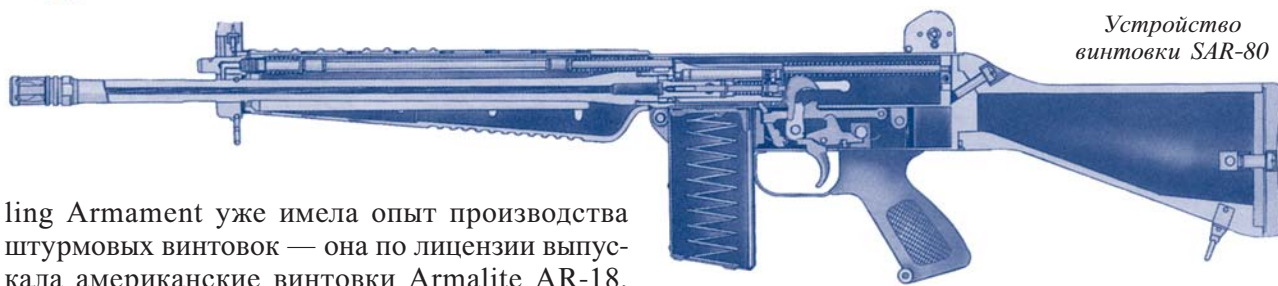
Сингапурский автомат SAR-80, разработанный на базе американской винтовки AR-18
