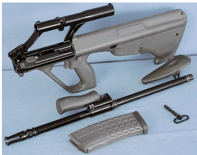
Неполная разборка автомата Steyr AUG (фото: Scottsdale Gun Club, США)
