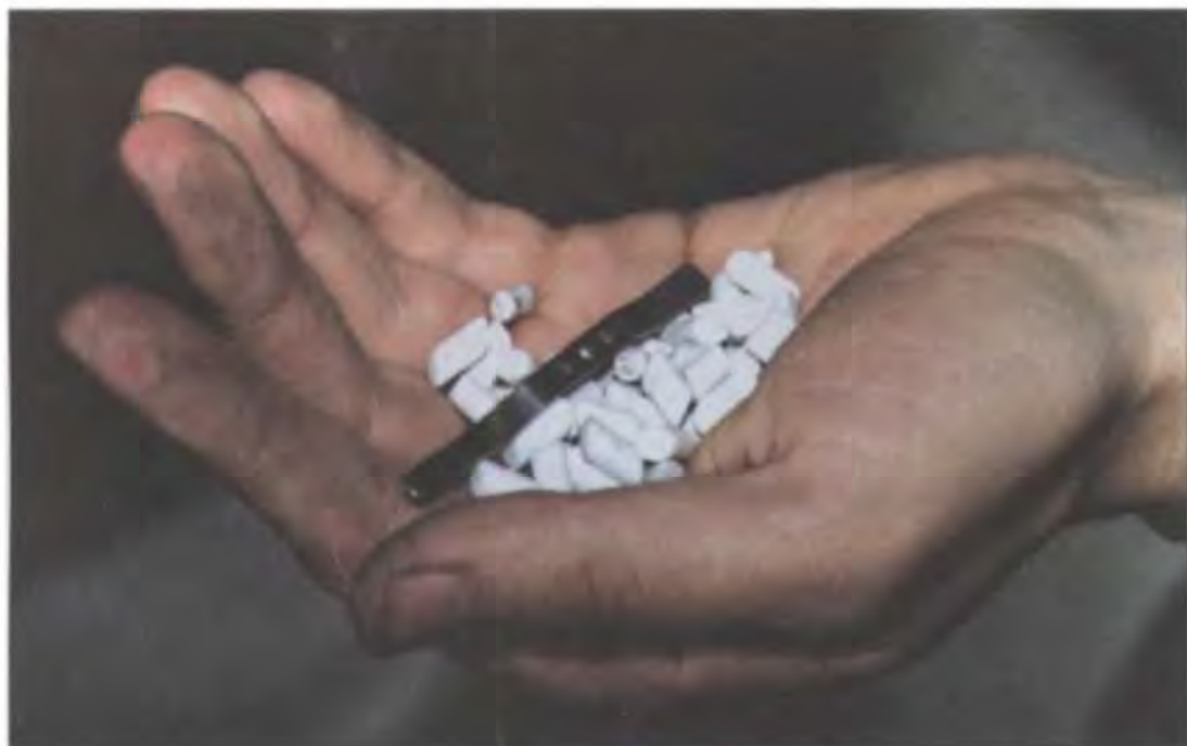
144. После «купания» в таких вот гранулках из мелкой белой керамики сталь выглядит намного благороднее, чем полированная
