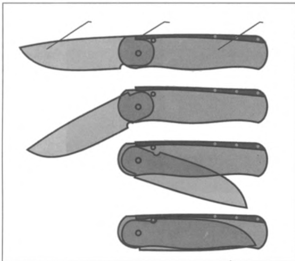
260. Так работает обыкновеннейший перочинный ножик с неблокируемым клинком. А – пружина, В – клинок, С – рукоятка
