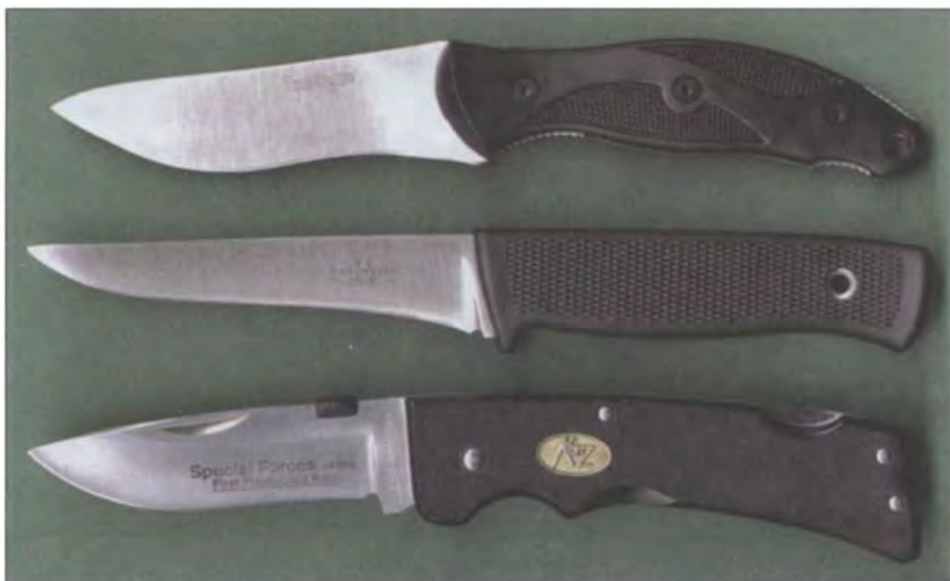
46. Вогнутый отрезок линии лезвия в задней части клинка помогает справиться с материалом, который плохо поддается ножу: например, перерезать мышцы, толстые артерии, рыбы кости. Сверху вниз: Kershaw Echo, Fällkniven F2, Katz Knives Special Forces
