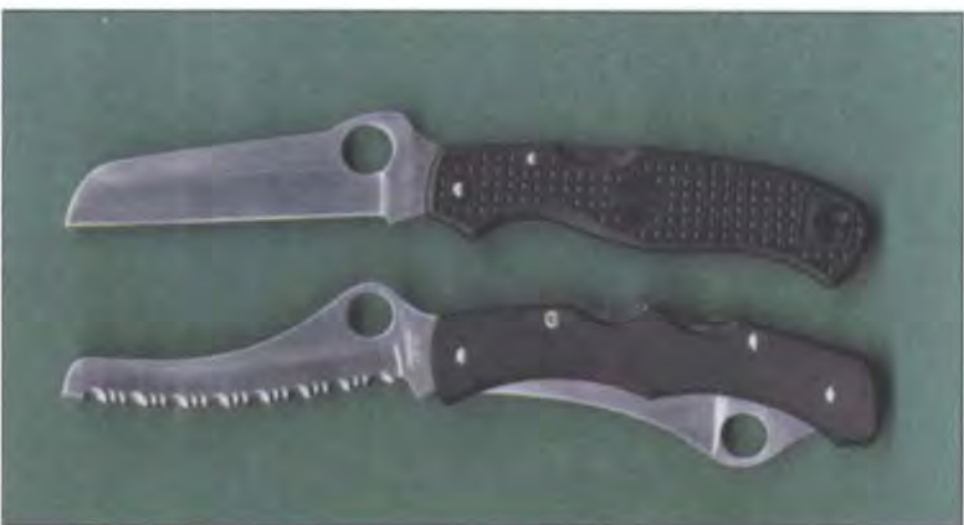
116. Такой тип клинка идеально подходит к ножам для спасательных работ – в частности к этим, изготовленным фирмой Spyderco: сверху – Rescue, внизу – Dyad
