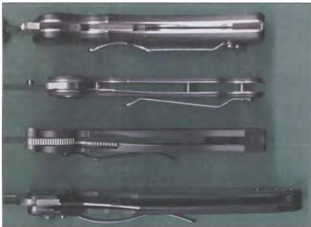
230. Несколько возможных вариантов конструкции. Сверху вниз: рукоятка ножа Katz Knives Carbon Fiber укреплена с обеих сторон пластинками из твердого алюминиевого сплава; у ножа М. Уокера и Х. П. Клётцли пластинки из титанового сплава тоже с обеих сторон; на рукоятке ножа CRKT M 16 Carbon Fiber пластинка только на одной стороне, она утоплена в оправу рукоятки; у SOG Jet Edge 2 пластинка тоже с одной стороны рукоятки. Подобного рода конструкция применяется и при использовании материала G-10
