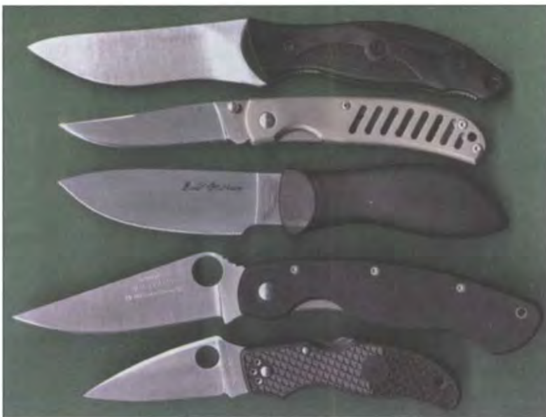
123. Ножи с полным плоским шлифом клинка. Сверху вниз: Kershaw Echo и Ti-Hawk, Spyderco Bill Moran Featherweight, Military и Calypso Junior Lightweight
