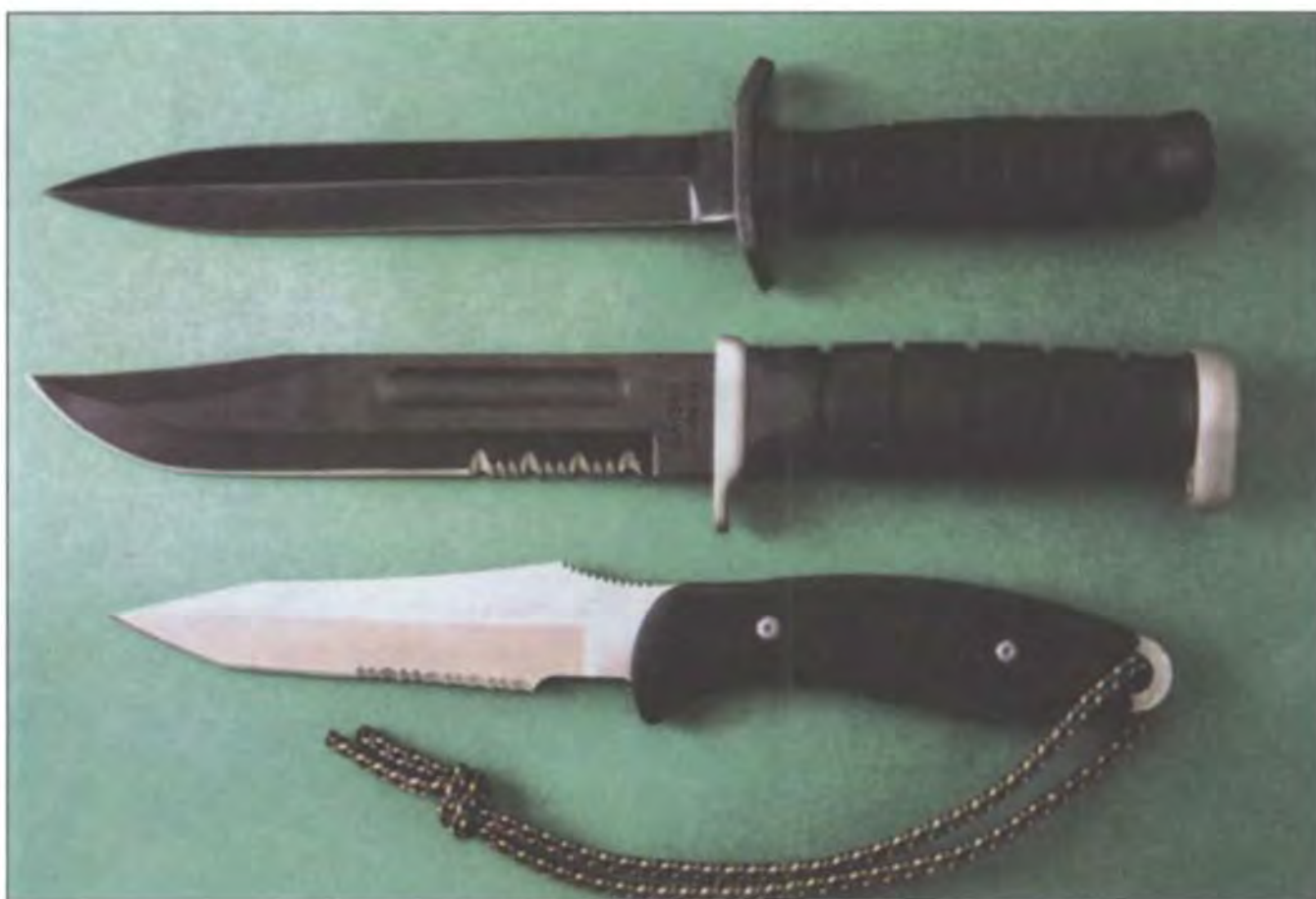
48. Типично боевые ножи. Стilet лодзинской фирмы Sanitas (сверху). Ка-Бар D2 Extreme Fighting/Utility Knife (посередине) – этот нож, как видно из его названия, предназначен для боя, но его можно использовать и как инструмент, годный для очень тяжелой работы (скажем, для рубки). SOG X-42 Recondo (внизу) мог бы стать вполне добротным инструментом, если бы не модная, но не очень практичная геометрическая форма пера
