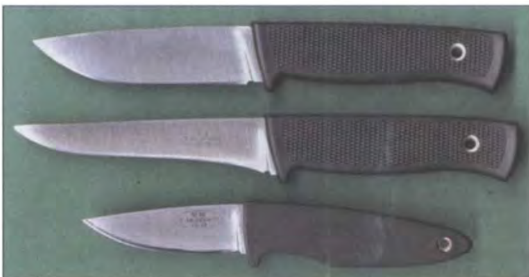
124. У клинков ножей Fällkniven полосы слегка выпуклые – по направлению от плашки к кончику, – и это делает переднюю их часть более выносливой. Сверху вниз: F1, F2, WM1
