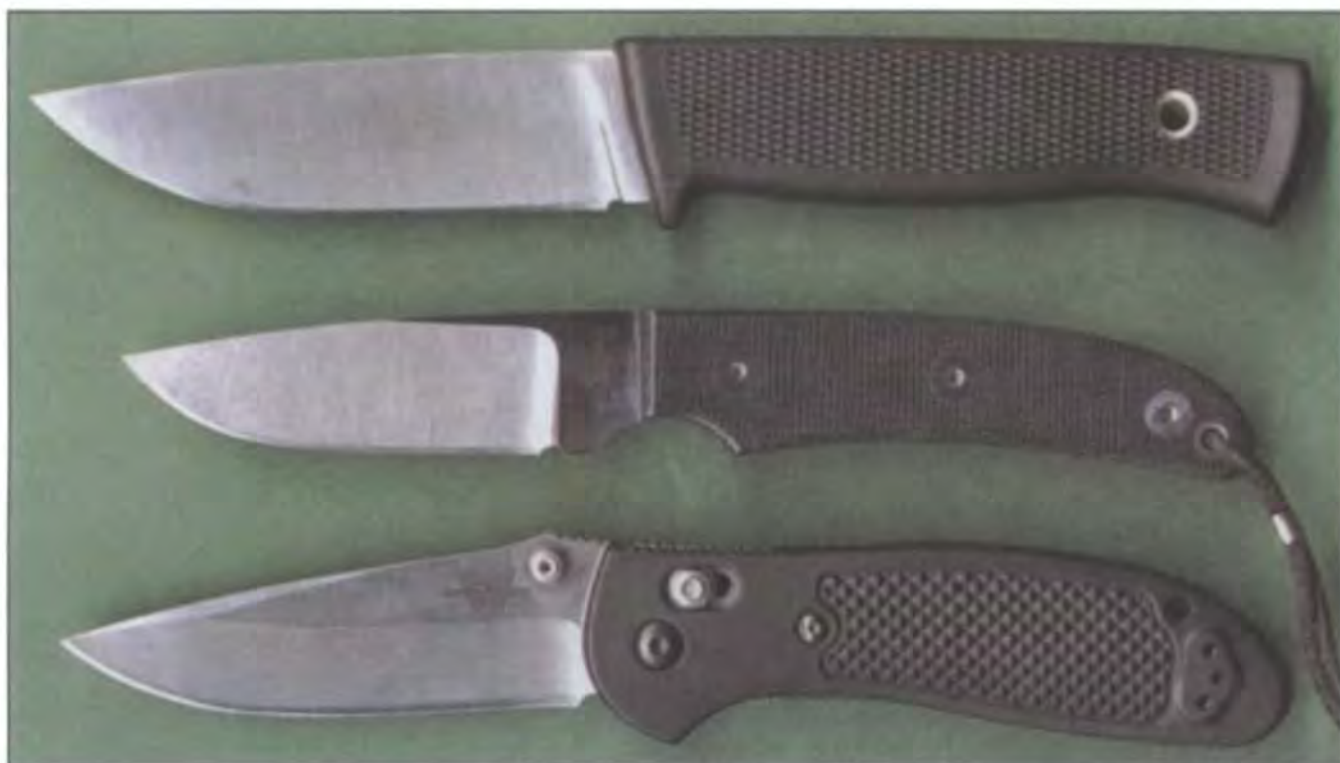
45. Клинки с выдвинутым вперед «брюхом» лезвия и прямым отрезком в задней его части. Сверху вниз: Fällkniven F1, Model 14 H.P.Klötzli, Benchmade Griptilian
