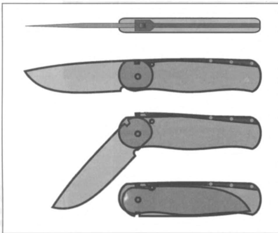
261. Если на пружине сделать вырез в форме петли, а в соответствующем месте клинка крючок в форме зуба, то при раскрытии ножа вырез зацепится за крючок и заблокирует клинок в раскрытом положении. Чтобы сложить нож, потребуется чем-нибудь приподнять пружину; это «что-то» на рисунке не показано, иначе на нем ничего нельзя было бы разобрать...
