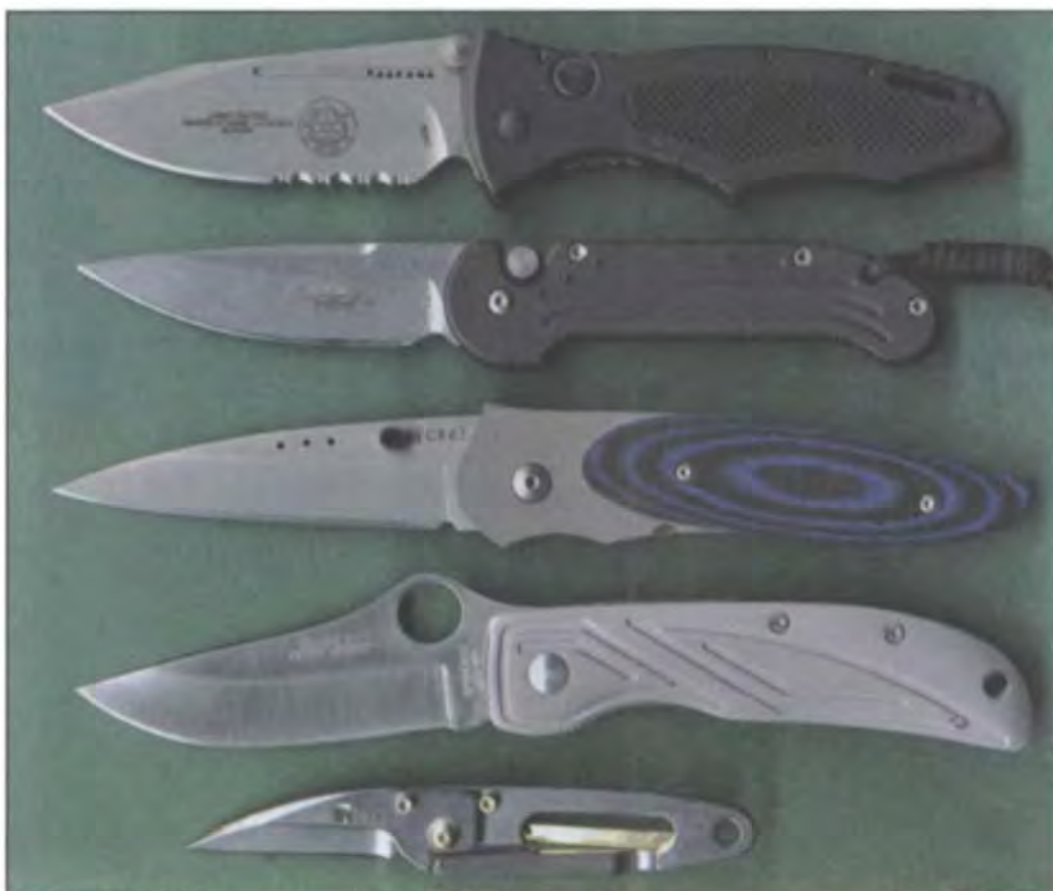
138. Несколько клинков, поверхность каждого из которых отделана по-разному. Сверху вниз: MOD Hornet Auto – bead blasting , Microtech UDT – stone washing , CRKT Wasp – frost , Spyderco Peter Herbst – сатинирование, CRKT-PECK Special Edition – полировка
