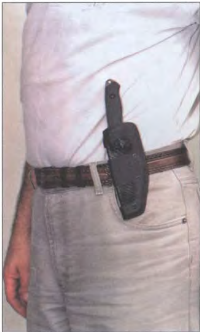
210. Очень высокая подвеска ножа Benchmade Nimgravus Cub на жестком стальном зажиме, закрепленном на ножнах
