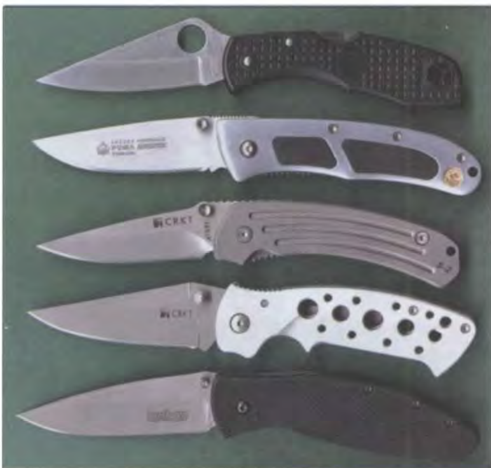
98. Несколько ножей с клинком clip point . Сверху вниз: Spyderco Delica, Puma Advantec, CRKT S-2 и компактная версия KFF Pro, Kershaw Avalanche. Клинки KFF и Avalanche усовершенствовали, добавив более или менее удлиненные ложные лезвия. Клинки ножей Advantec, S-2 и Avalanche показывают, как ничтожно мало может быть различие между drop point и clip point
