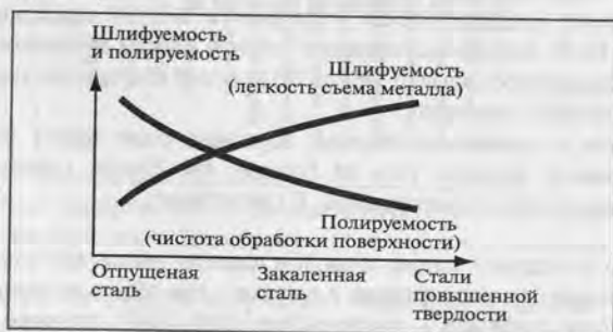
Рис. 56. Зависимость показателей абразивной обработки стали (шлифуемости и полируемости) от твердости.
