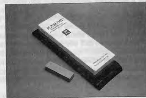
Рис. 60. Комбинированный камень на держателе. Верхняя часть для заточки, нижняя для подводки. Малютка слева – для создания первичного слоя суспензии.
