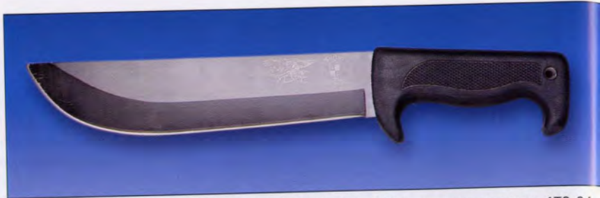
Нож фирмы United Cutlery, модель UC934 SPECIAL OPS с клинком из стали ATS-34 и рукоятью из нескользящего резинопластика с рифленной поверхностью, закрепленная на хвостовике трубкой из коррозионнстойкой стали.
