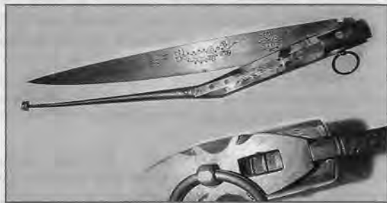
Рис. 69. Замок-трещотка на испанской навахе середины XIX века.
