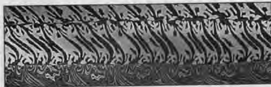
Рис. 31. Фрагмент клинка из «мозаичного» дамаса. Мастер В.О. Сосков.
