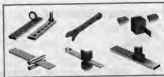
Рис. 30. Основные техники развития узора. Слева направо: предварительная фрезеровка и засверливание с последующей прокаткой; кручение с последующей расковкой; штамповка поверхности фасонными бойками с последующей холодной шлифовкой.
