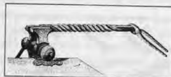
Рис. 26. Торсирование (закручивание) прямоугольного сварного пакета в горячем состоянии с целью развития «крученого» узора.
