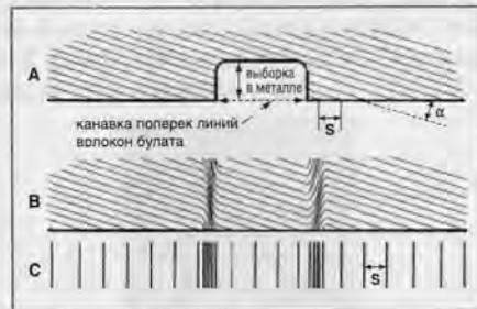
Рис. 13. Механизм развития узора «лестница»: А – продольный разрез клинка (где альфа – угол выхода на поверхность обогащенных углеродом волокон, s – расстояние между ними), поверхность которого насекается или надрезается, а затем проковывается. В результате низ выемки поднимается к верхним слоям (В), а на поверхности клинка формируется пара дополнительных искажений (С).
