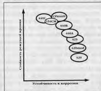
Рис. 17. Сравнительные свойства наиболее популярных марок коррозионностойких сталей.
