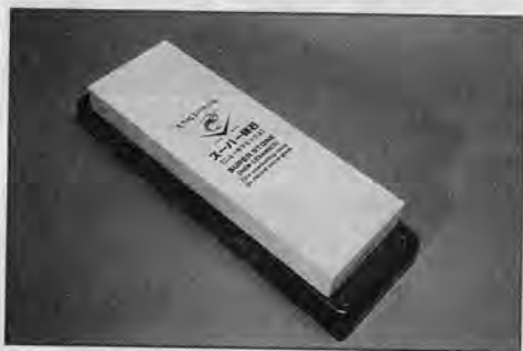
Рис. 61. Классический японский водный камень искусственного происхождения от фирмы Naniwa на пластиковом держателе: традиция и современность.
