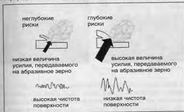
Рис. 47. Зависимость чистоты поверхности от воздействующего на абразив усилия.
