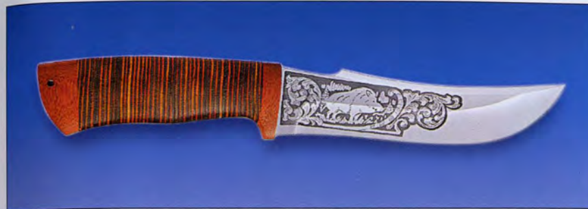
Компания АйР, нож "Клык" – клинок из коррозионнстойкой стали 40X10C2M с изображением, выполненным методом химического травления. Рукоять наборная из кожи, с прибором из текстолита.
