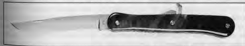
Рис. 70. Первые ножи с фиксатором не имели заделки свободного конца коромысла в плотай. Напротив, выступ коромысла выпирал гордым горбом на спинке рукояти.
