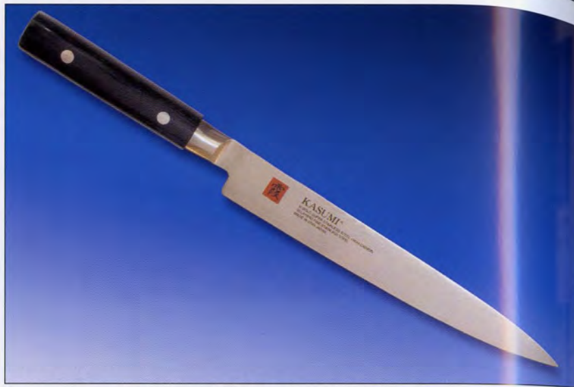
Нож от фирмы SUMIKAMA CUTLERY MFG. CO. LTD (KASUMI) с клинком из многослойного пакета: сердцевина из стали VG-10, обкладки из многослойной (32 слоя) узорчатой стали. Материал рукояти – слоистый древесный пластик.
