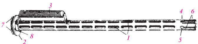
Кожух ствола: 1 — продольные окна; 2 — соединительная шайба; 3 — ручка; 4 — прямоугольный вырез; 5 — выступ; 6 — сухарные выступы кожуха; 7 — сухарные выступы соединительной шайбы; 8 — отверстие для пальца ограничителя отката ствола
