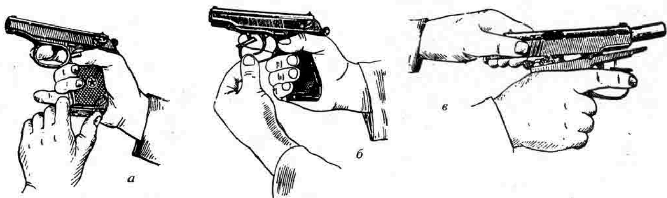
Неполная разборка пистолета:
