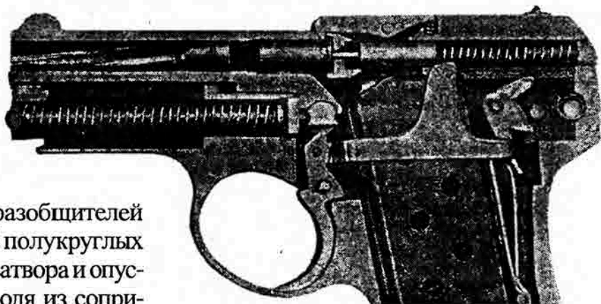
Положение частей пистолета в момент выстрела
