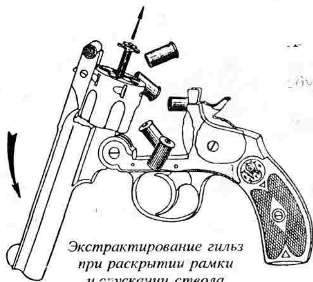
Экстракция гильз в револьвере Томаса: а — ствол в боевом положении; б — ствол и барабан в крайнем переднем положении
