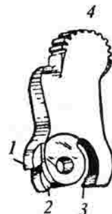
Курок: 1 — предохранительный выступ; 2 — боевой выступ; 3 — дуговой паз; 4 — головка
